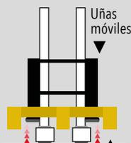
Se requiere el uso de tarima con zanco libre, para el funcionamiento de este montacargas.
